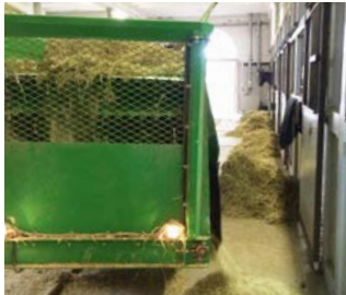
▲ Ny teknik förenklar vardagen i Flynges 200 år gamla hingststall. Fodertruck med inbyggd våg samt (ut)matarbord som här portionerar ut hösilagegiva vid hästbox.
