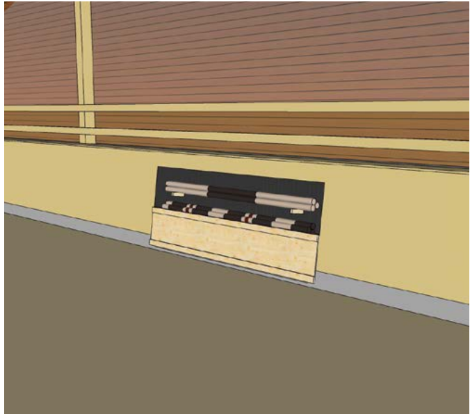
▲ Exempel på förvaring av hinderbommar i sargen. Lucka med dolda beslag och konsoler för upplag av bommarna. Klicka för fler bilder.
