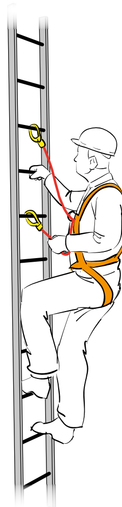
Figur 26. Förankring med stegkrokar i dubbla kopplingslinor.
